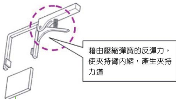
圖三 目前夾持器之槓桿式連動機構
